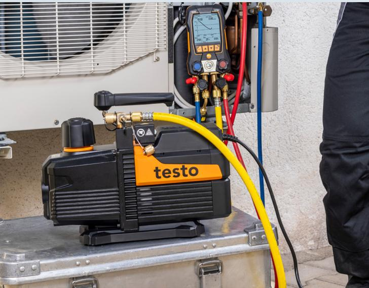
Rückschlagventil zur Vermeidung von Vakuumverlust bei Stromunterbrechung.
